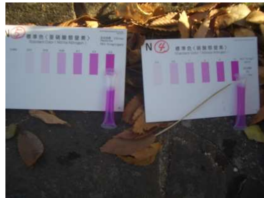
下流地点での測定状況 (パックテスト)
